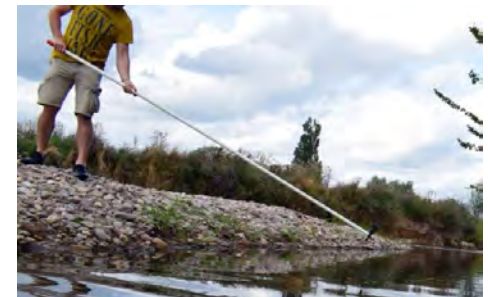
Abb. 22: Sondenkamera = Teleskopstab + ActionCam ( GESCHÄFTSSTELLE GEWÄSSERÖKOLOGIE, 2022 )
